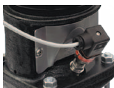
Установка промышленного сенсора
